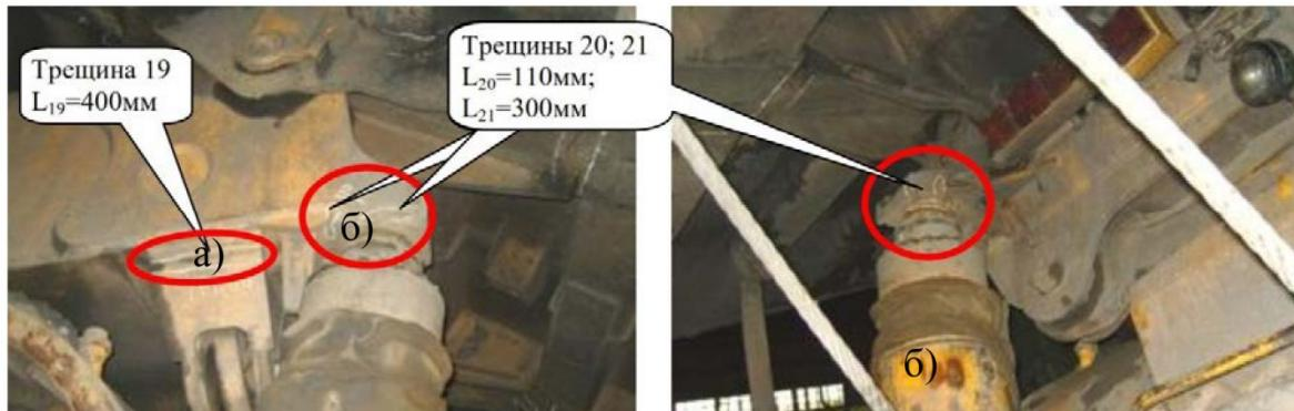
Рис. 1. Трешины сварного соединения верхнего крепления реактивной штанги на левом лонжероне (а) и основного металла верхней пластины основания крепления шаровой опоры и самой шаровой опоры (б) автосамосвала БелАЗ-75131
