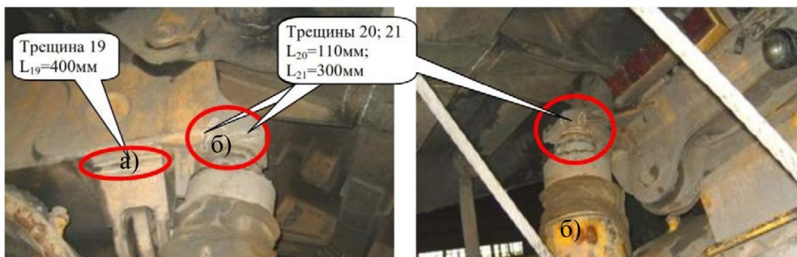
Рис. 1. Трещины сварного соединения верхнего крепления реактивной штанги на левом лонжероне (а) и основного металла верхней пластины основания крепления шаровой опоры и самой шаровой опоры (б) автосамосвала БелАЗ-75131
