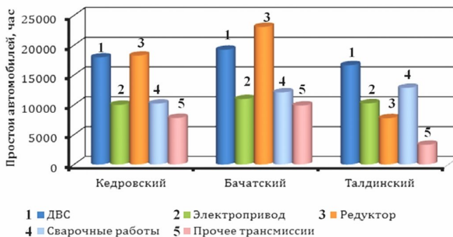
Рис. 1. Диаграмма основных причин простоев автосамосвалов на разрезах Кузбасса в 2012 году
