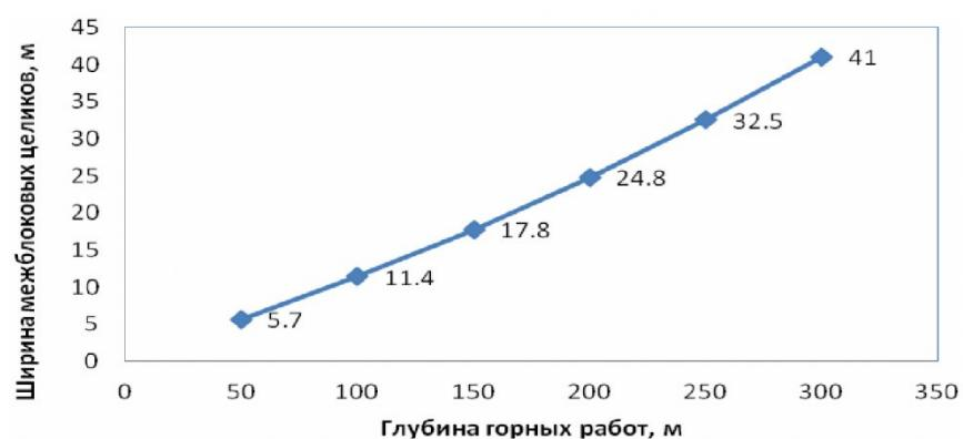
Рис. 6. Зависимость расчетной ширины межблоковых целиков в камерной системе разработки от глубины работ
