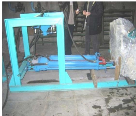
Рис. 1. Станок буровой породный СБП с пневмоударником АШ: а – общий вид станка; б – опытный образец на стенде
