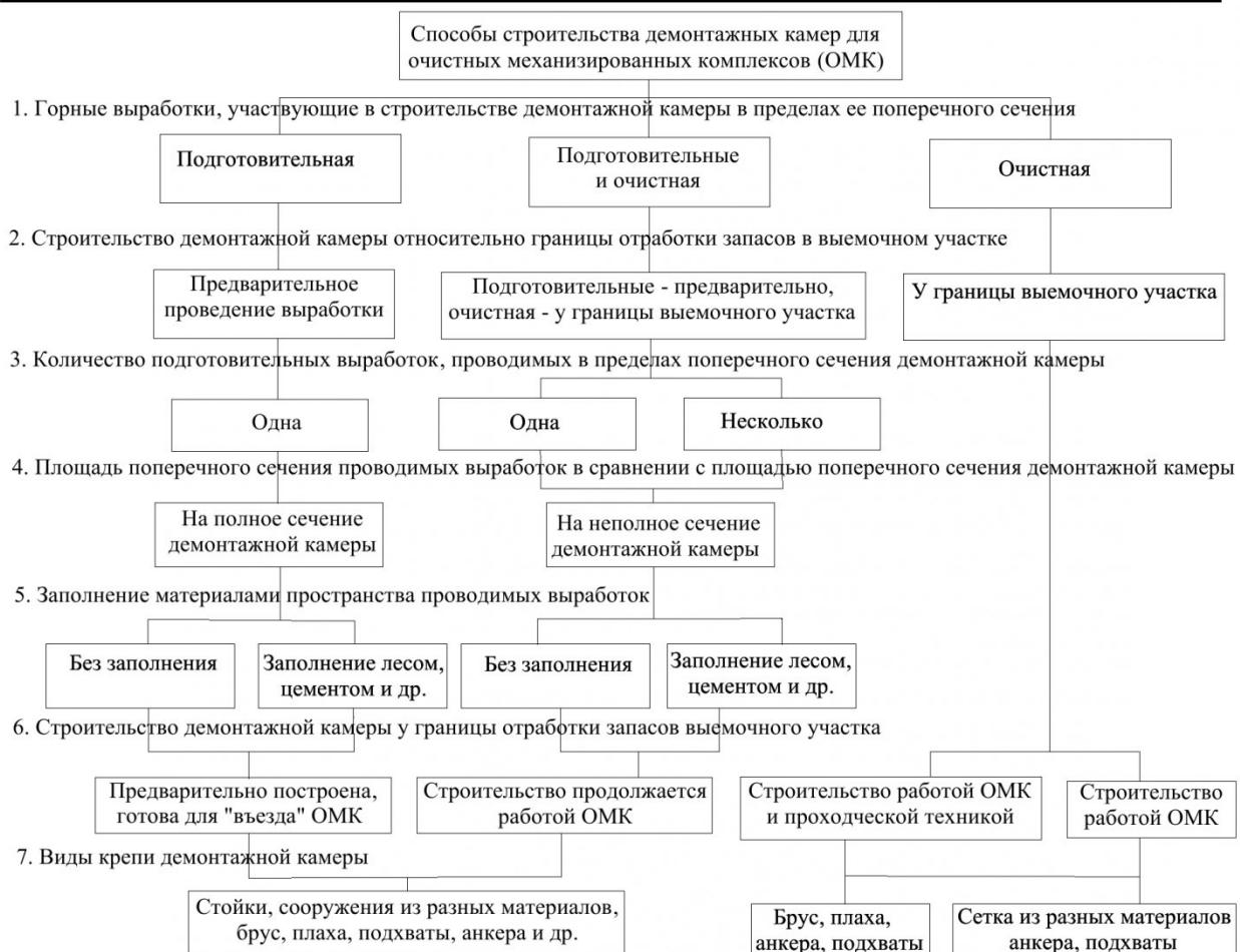
Рис. 1. Классификация способов строительства демонтажных камер для очистных механизированных комплексов при отработке столбовыми системами пологих угольных пластов
