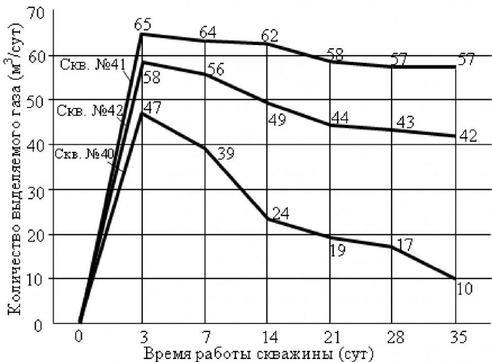
Рис. 2. Газовыделения в дегазационные скважины 40, 41, 42, пробуренные параллельно по восстанию пласта 7-7а
