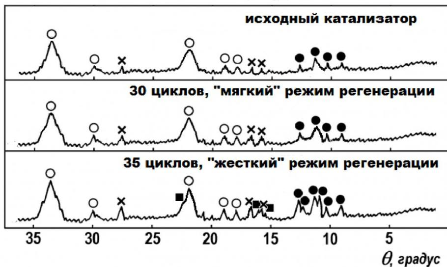
Рис. 2. Рентгенограммы исходного АМХН-катализатора и АМХН-катализатора, подвергнутого циклическим обработкам с «мягким» и «жестким» режимами регенерации. Условные обозначения:  $\circ$  - шпинельная фаза ( $\gamma\text{-Al}_2\text{O}_3$ );  $\times$  -  $\alpha\text{-Cr}_2\text{O}_3$ ;  $\bullet$  - «молибдатная» фаза
