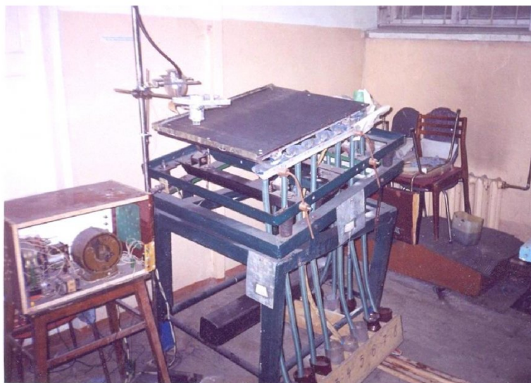
Рис. 2. Внешний вид вибрационного сепаратора для разделения шлифовальных зёрен по форме
