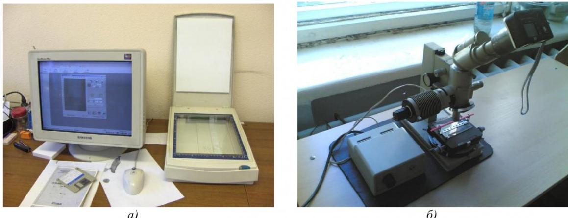
Рис. 3. Оборудование для получения изображений шлифовальных зёрен: а) сканер и компьютер, б) микроскоп и цифровой фотоаппарат
