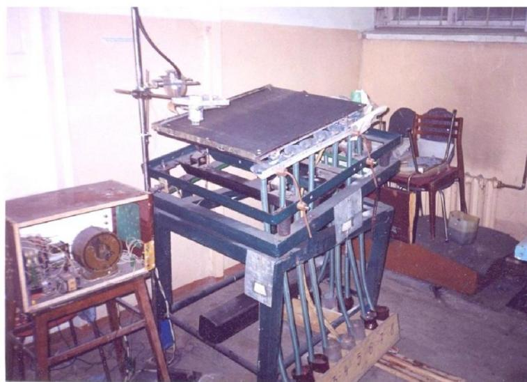
Рис. 2. Внешний вид вибрационного сепаратора для разделения шлифовальных зёрен по форме
