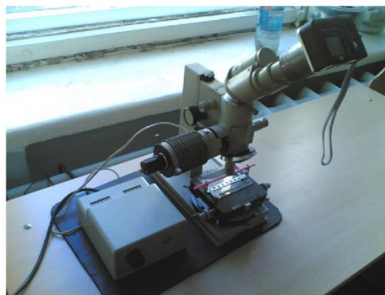
Рис. 3. Оборудование для получения изображений шлифовальных зёрен: а) сканер и компьютер, б) микроскоп и цифровой фотоаппарат
