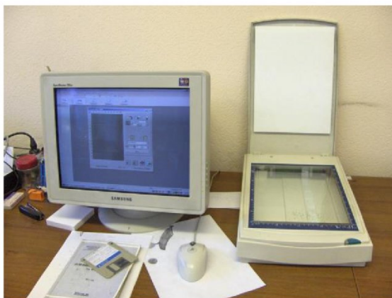
Рис. 3. Оборудование для получения изображений шлифовальных зёрен: а) сканер и компьютер, б) микроскоп и цифровой фотоаппарат
