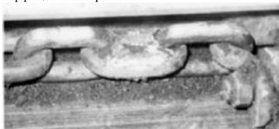
Рисунок 3 Измерительное звено тяговой цепи скребкового конвейера
