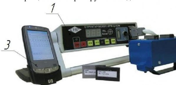
Рис. 8. Внешний вид магнитного структуроскопа КРМ-Ц-К2М:
