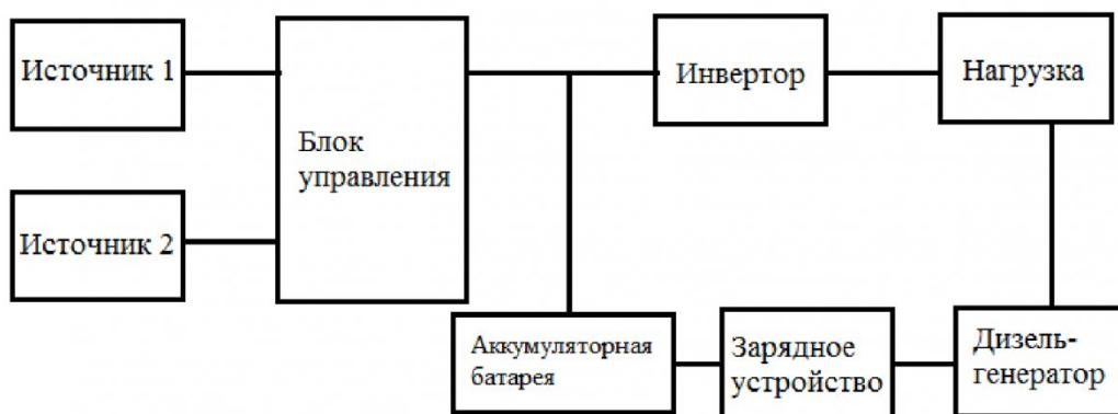
Рис. 3. Структурная схема АСЭ №3
