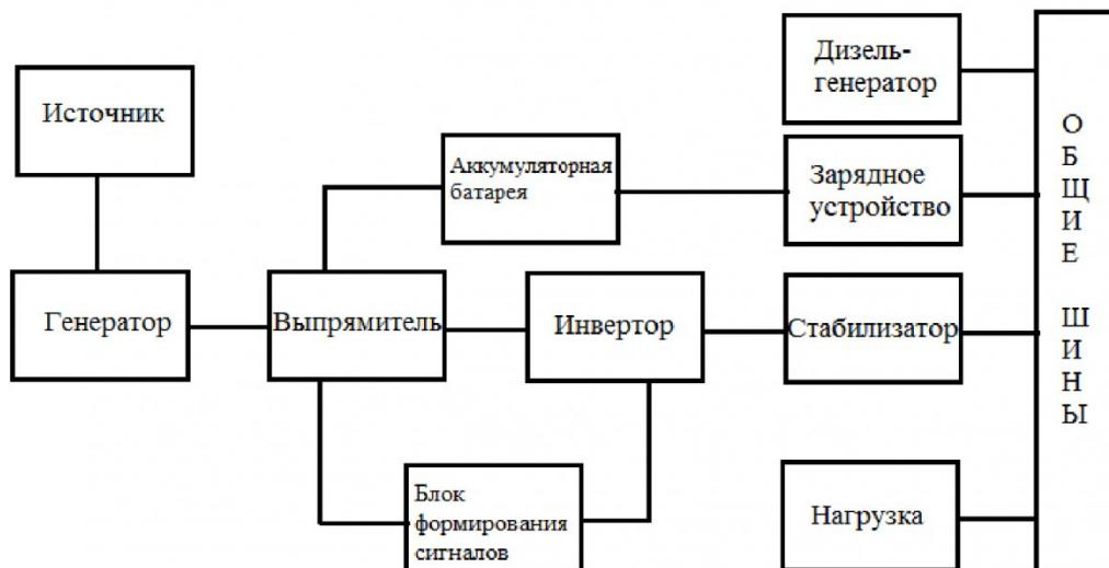
Рис. 2. Структурная схема АСЭ №2
