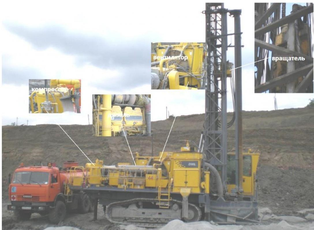
Рис. 7. Объект диагностирования – дизель-гидравлический буровой станок DML-1200
