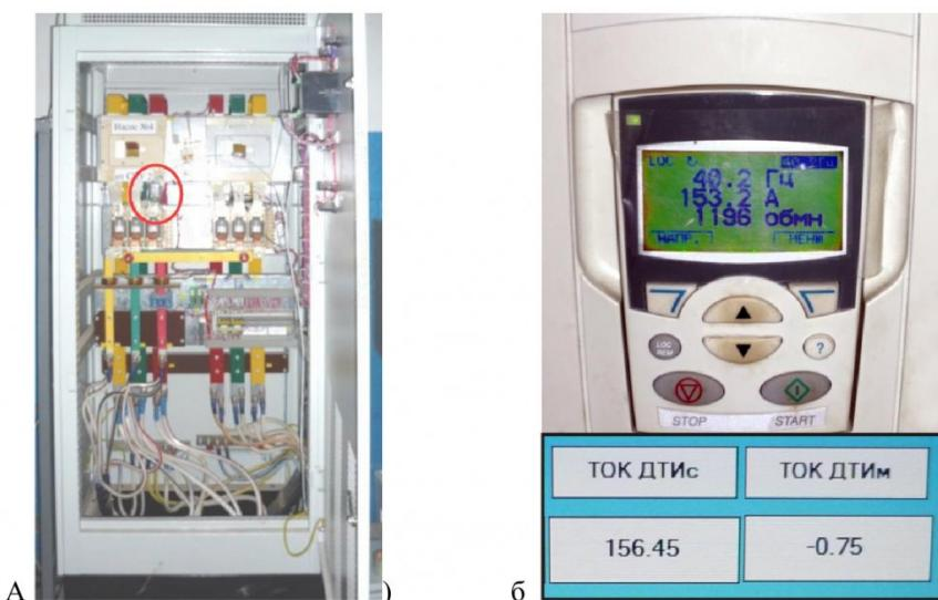
*Рис. 10. Промышленные испытания датчиков тока изолированных среднеквадратичных: а) установка в блоке преобразователя частоты; б) показания тока, измеренного промышленным преобразователем частоты, и показания датчиков тока изолированных в настраиваемом пользовательском интерфейсе SCADA системы*
