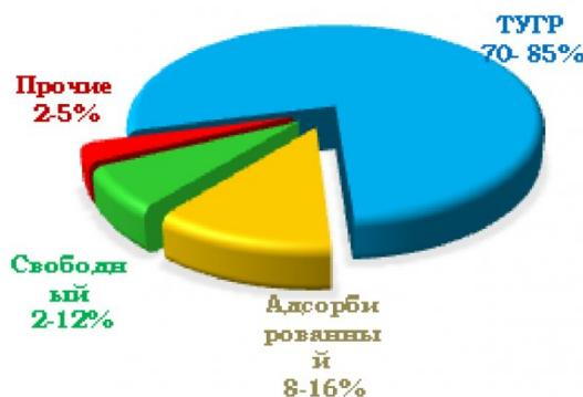
Рис. 1. Структура газоносности угольного пласта
