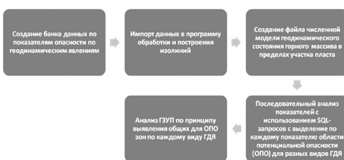
Рис. 2. Структурная схема работы многоуровневой ГИС-модели ГЗУП
