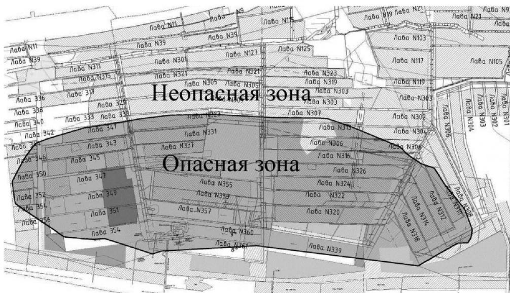
*Рис. 6. Опасная по внезапным выбросам угля и газа зона (выделенный контур) на плане горных работ участка пласта 3, построенная методом ГЗУП*
