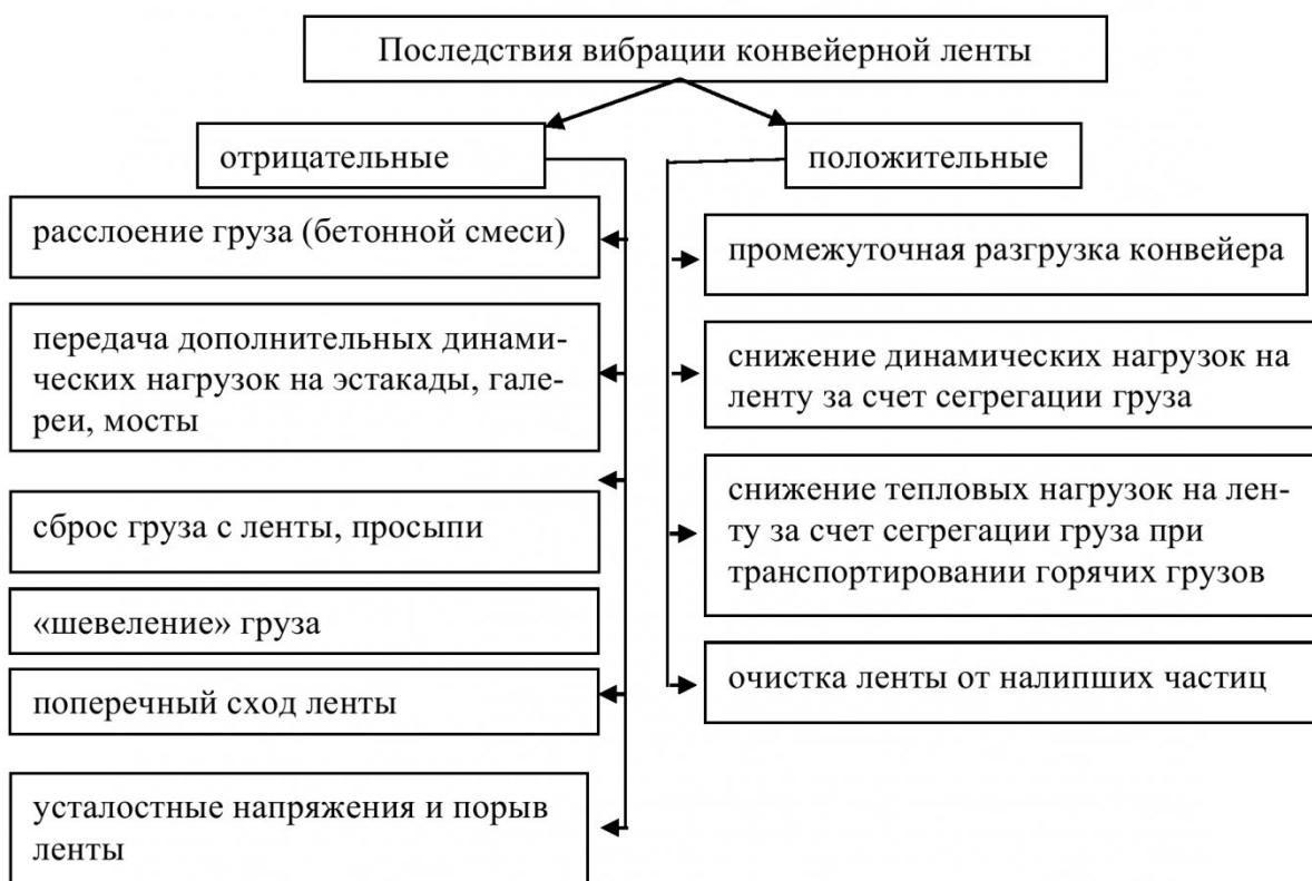
Рис. 2. Последствия вибрации конвейерной ленты
