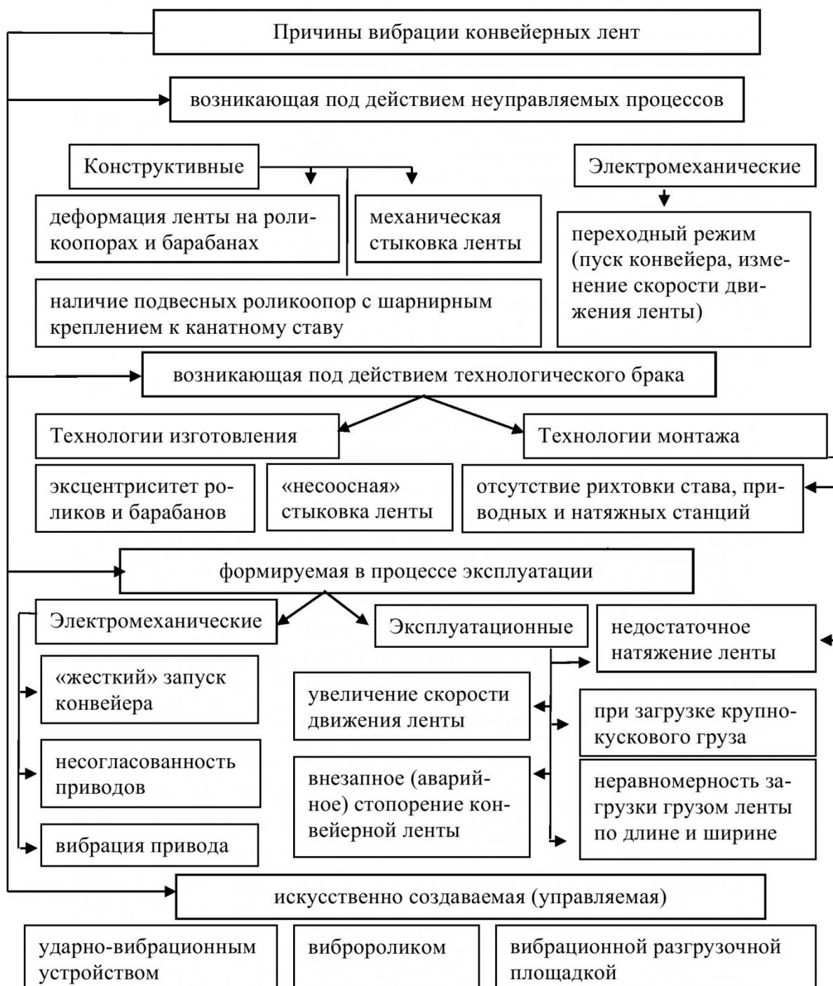
Рис. 1. Причины вибрации конвейерных лент
