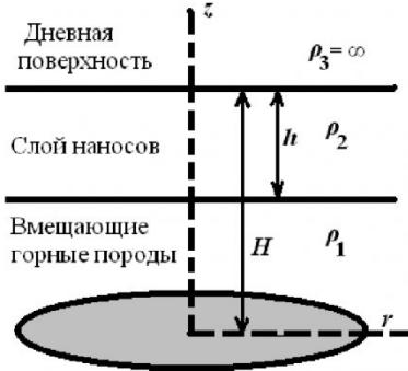
Рис. 1. Схема вмещающего пространства и плоского источника поля
