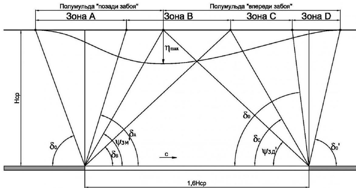
Рисунок 3 - Зоны сдвижения А, В, С и Д в сформированной микромульде при положении очистного забоя  $D_{2X} = 1,6H_{Cp}$  на разрезе по простирианию лавы.
