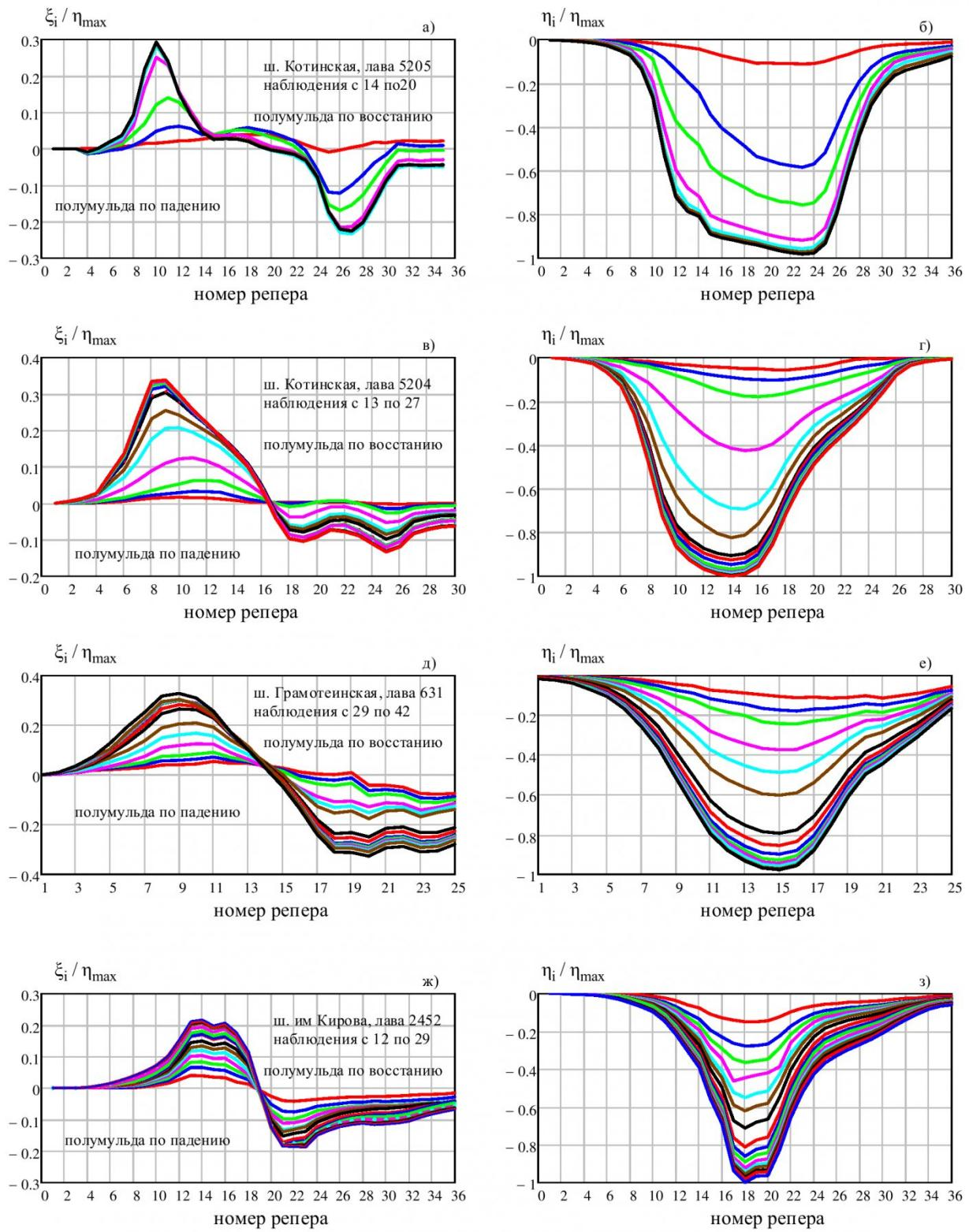
Рисунок 1 - Примеры развития относительных горизонтальных и вертикальных составляющих сдвижений земной поверхности вкрест простириания пласта по мере прохождения лавы под профильными линиями: а), б) – шахта «Котинская», лава № 5205; в), г) – шахта «Котинская», лава № 5204; д), е) – шахта «Грамотеинская», лава № 631; ж), з) – шахта им. Кирова, лава № 2452.
