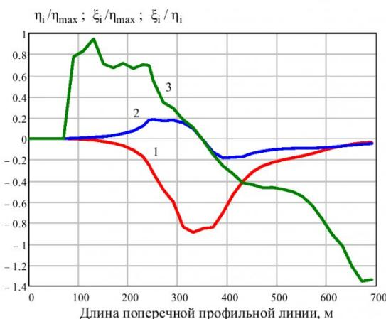
Рисунок 8 - Фрагмент состояния динамической мульды сдвигений вкrest простириания пласта при фиксированном положении очистного забоя.
