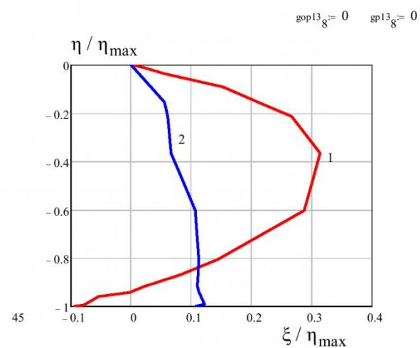
Рисунок 6 - Характер сдвижения репера R21 (R13), расположенного на пересечении профильных линий наблюдательной станции на шахте «Грамотеинская», лава 631: 1 – по простирию, 2 – вкрест простирия.
