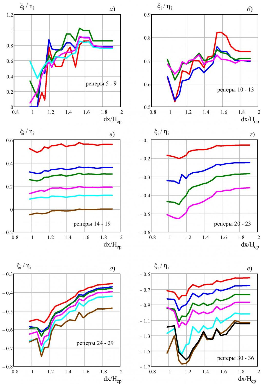
Рисунок 9 - Закономерности изменения отношения горизонтальных сдвигений к оседаниям отдельных точек земной поверхности в профильной линии вкрест простирания в зависимости от положения под ней очистного забоя лавы.
