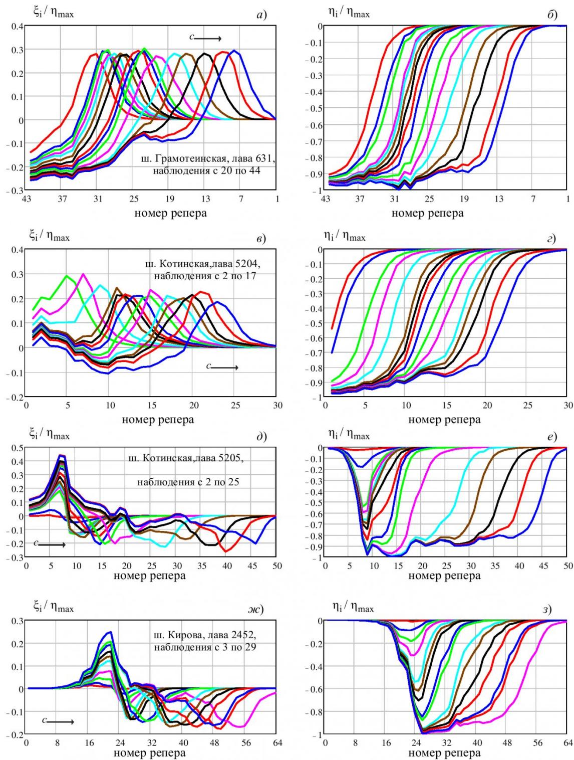
Рисунок 2 - Примеры развития относительных горизонтальных и вертикальных составляющих сдвигов земной поверхности по простирианию пласта по мере подвигания забоя лавы со скоростью ( $c$ ): а), б) – шахта «Грамотеинская», лава № 631; в), г) – шахта «Котинская», лава № 5204; д), е) – шахта «Котинская», лава № 5205; ж), з) – шахта им. Кирова, лава № 2452.
