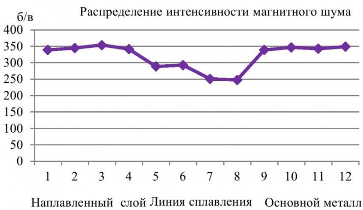
Рис. 8. Распределение интенсивности магнитного шума по поверхности зубчатого венца от наплавленного слоя к основному металлу
