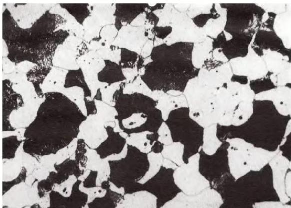
Рис. 3. Микроструктура исходного состояния стали 40Л
