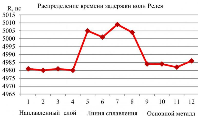
Рис. 7. Распределение времени задержки ПАВ по поверхности зубчатого венца от наплавленного слоя к основному металлу
