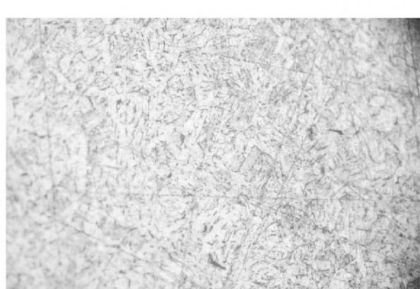
Рис. 6. Микроструктура наплавленного металла корпуса ступиц РМЕ:
