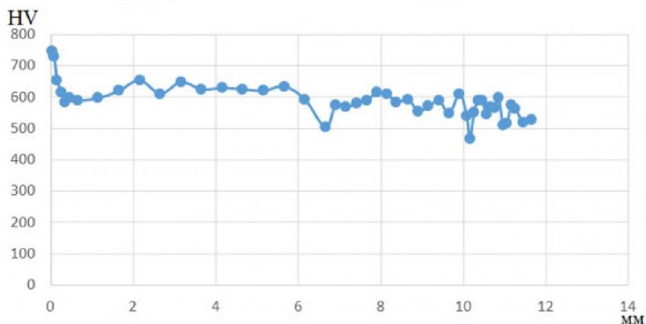
Рис. 4. Распределение значений твердости HV в поперечном сечении оси
