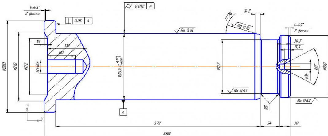
Рис. 2. Чертеж детали «ось» экскаватора P&H 4100 XPC
