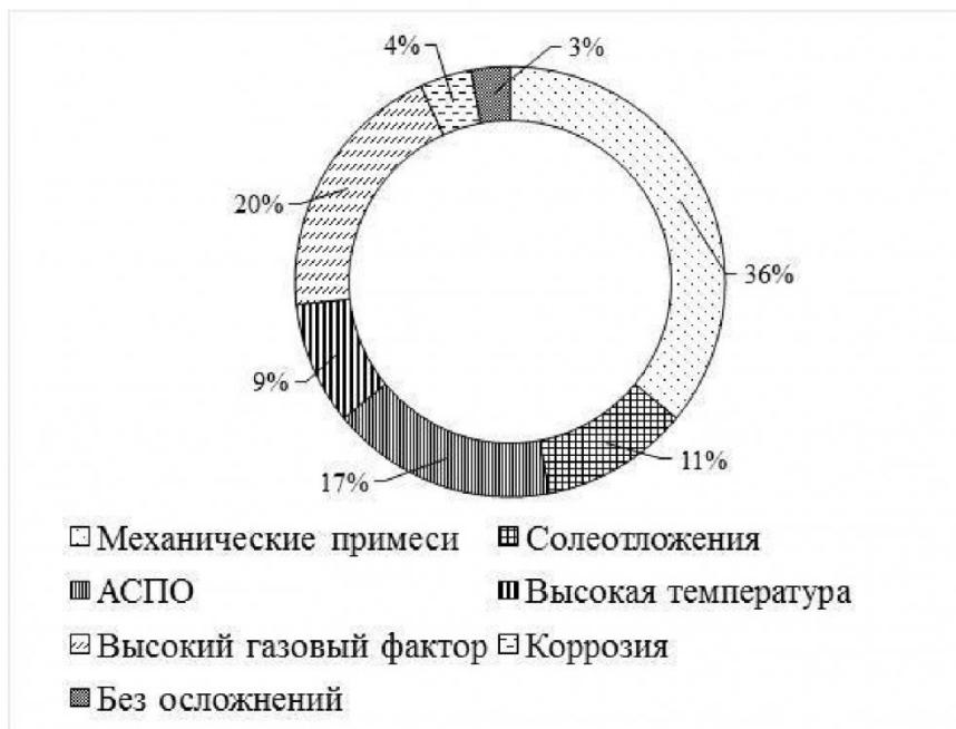
Рисунок 2 – Причины отказов УЭЦН в ООО «РН-Пурнефтегаз»
