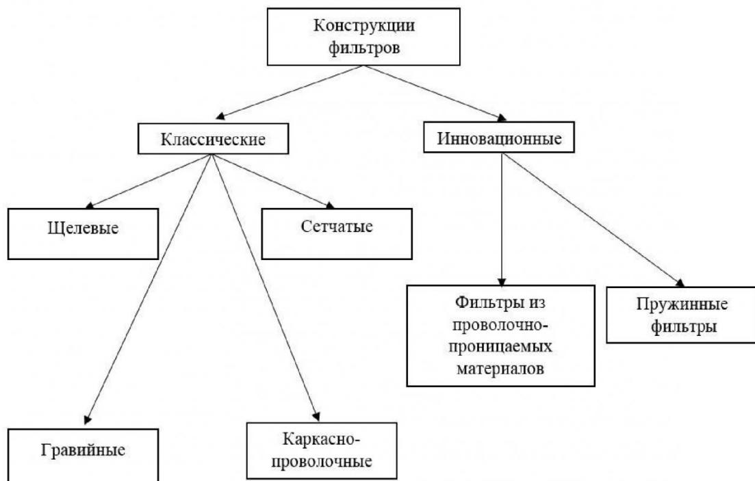
Рисунок 3 – Конструкции фильтров
