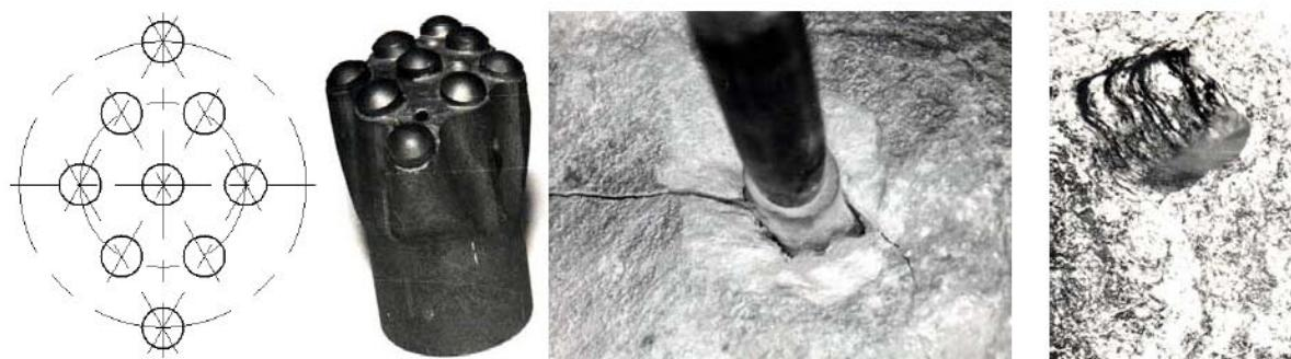
Рис. 3. Бурение шпуря ромбического сечения
