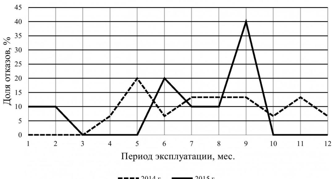
Рис. 5. Совмещенный график распределение отказов по месяцам за 2014-2015 гг.
