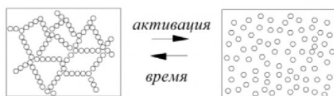
Рис. 2. Схема тиксотропных изменений Fig. 2. Scheme of thixotropic changes
