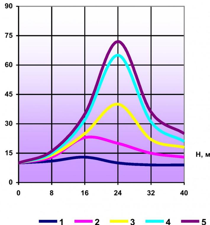
Рис. 1. Изменение температуры угля  $t^\circ$  по высоте  $H$  опытной камеры при формировании в ней очага самовозгорания: 1, 2, 3, 4, 5 – при величине  $P_e \cdot F_o$ , равный соответственно  $1 \cdot 10^3$ ;  $2,3 \cdot 10^3$ ;  $4,7 \cdot 10^3$ ;  $8,7 \cdot 10^3$
