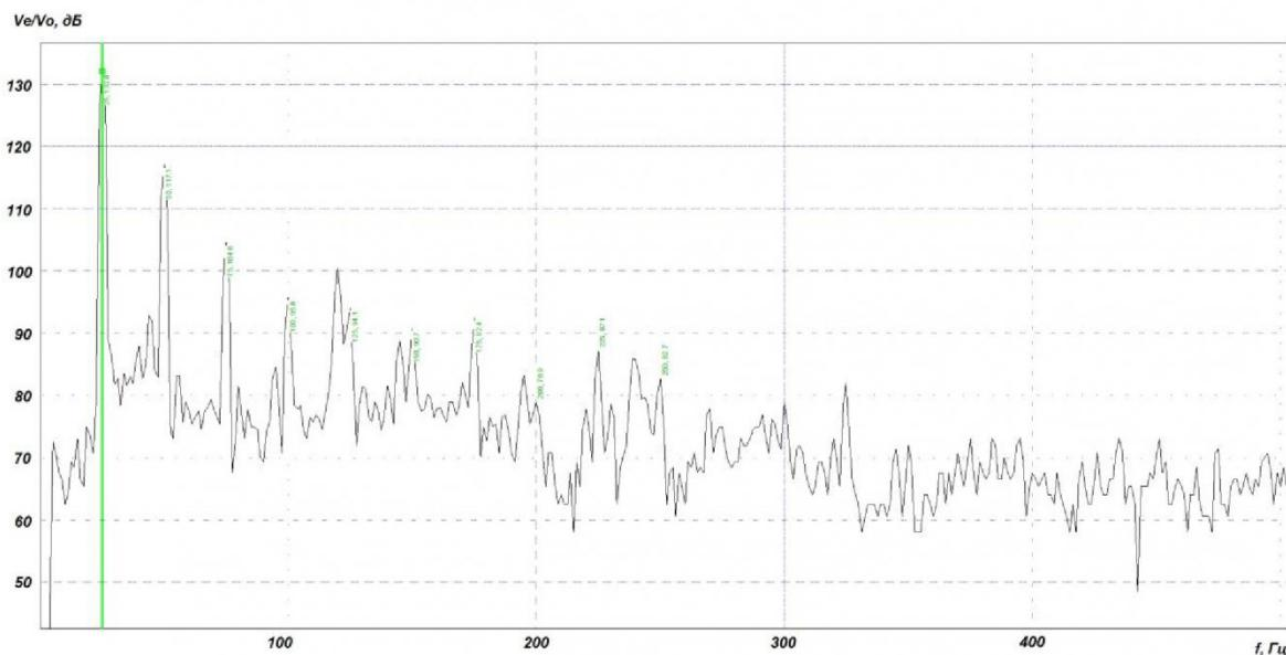
Рис. 5. Логарифмическое представление спектра полигармонической волны, иллюстрирующее недопустимый дисбаланс ротора генератора подъема экскаватора ЭКГ-5А. Общий уровень по параметру выброскорости  $VeCK3=40,1$  мм/с.
