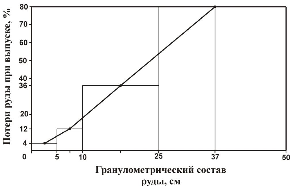
Рис. 1. Зависимость потерь руды при выпуске вследствие ее смерзания от гранулометрического состава выпускаемой руды
