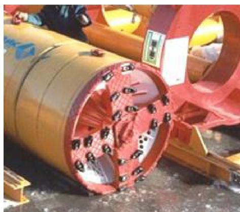
а) Исполнительный орган установки горизонтального бурения типа УГБ
