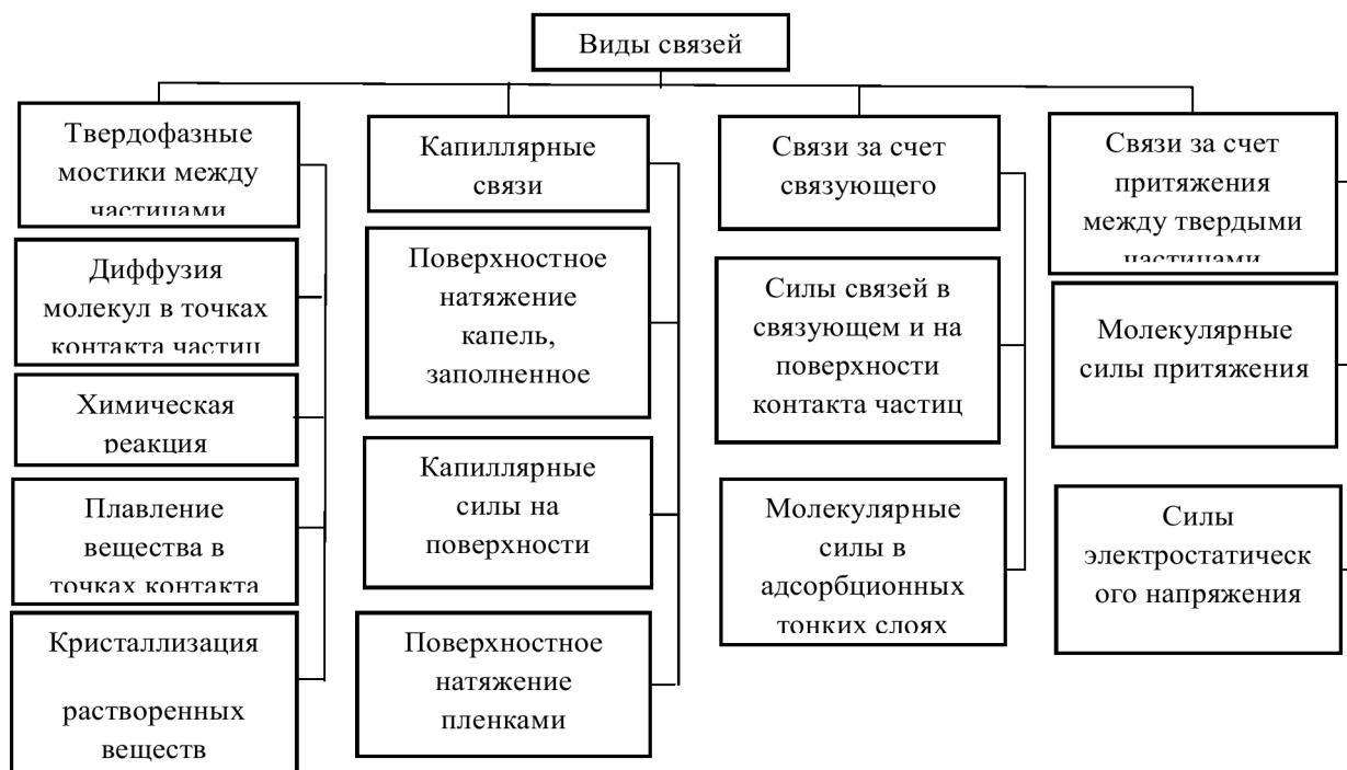
Рис. 1. Классификационная схема связей при гранулировании
