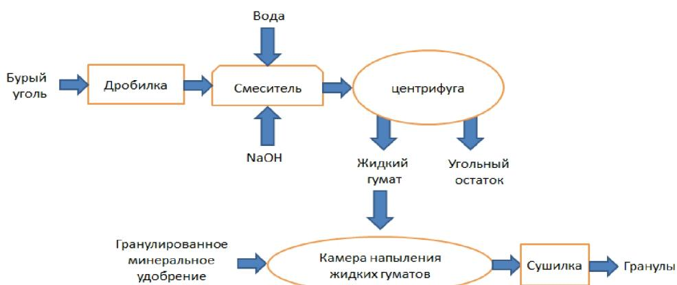
Рис. 3. Схема технологии гранулирования методом плакирования
