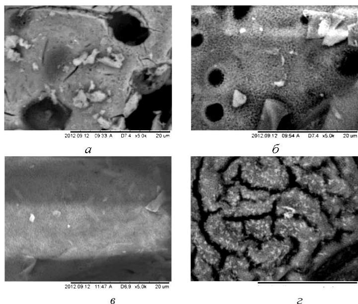
Рис. 2. Микрофотографии образцов алюмината кальция, полученных отжигом прекурсоров, высущенных под воздействием микроволнового излучения, синтезированных при мольном соотношении  $\text{Ca}^{2+} : \text{Al}^{3+}$ :
