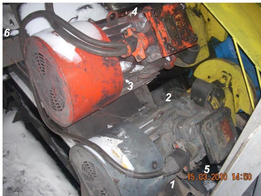
*Рис. 1. Схема проведения измерений параметров вибрации на высокочастотном грохоте.*
