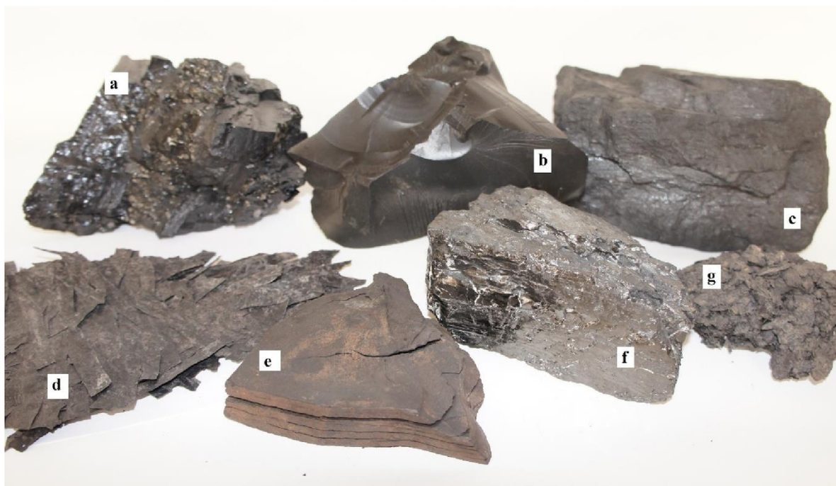
Рис. 1. Фрагмент угольной коллекции, систематизированной по разнообразию физических свойств. Угли каменные: а-грубополосчатый с угловатым изломом; с-дюрен штриховатый; ф-дюренокларен полосчатый с неровным изломом. Угли сапропелевые: б-матовый с раковистым изломом; е-матовый с волокнистым изломом; Барзассит: д-листоватой структуры; г-брекчиевидный с землистым изломом). Fig. 1. Part of coal collection, which is structured by physical properties.
