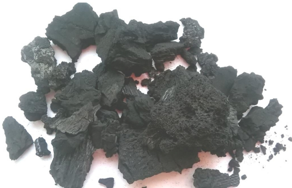
Рис. 1. Твердый углеродный остаток пиролиза автошин Fig. 1. The solid carbon residue tire pyrolysis
