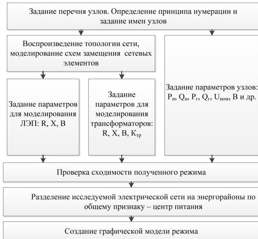
Рис. 1. Алгоритм создания расчётной модели
