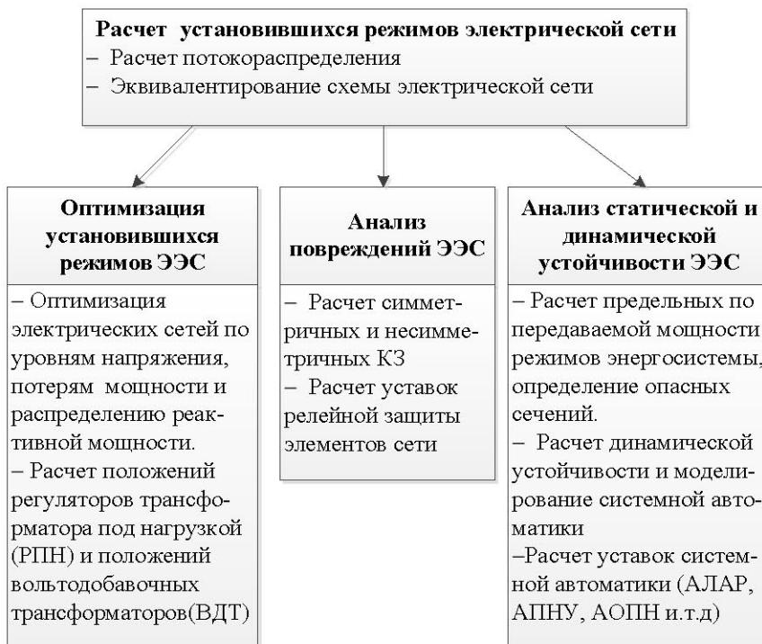
*Рис.1. Электросетевые задачи, решаемые в процессе управления режимами ЭЭС*
