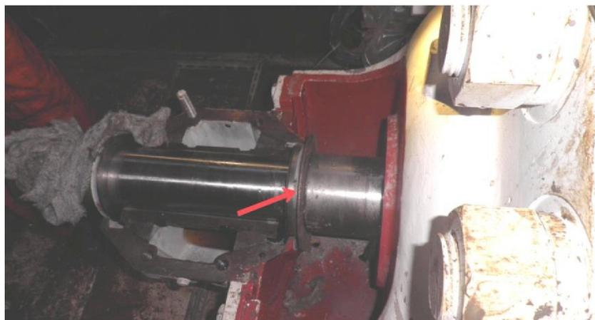
Рис. 2. Гидроабразивный износ элемента переднего торцевого уплотнения
