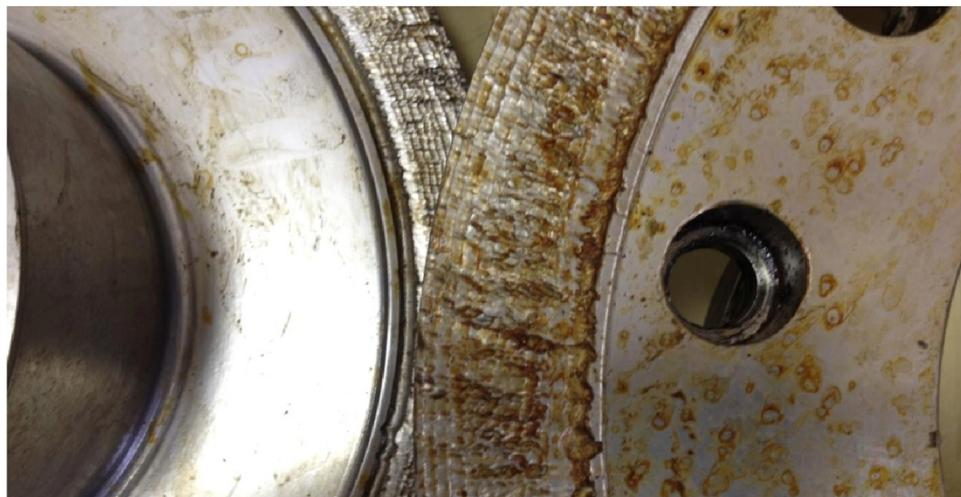
*Рис. 5. Гидроабразивный износ диска и кольца гидропяты
