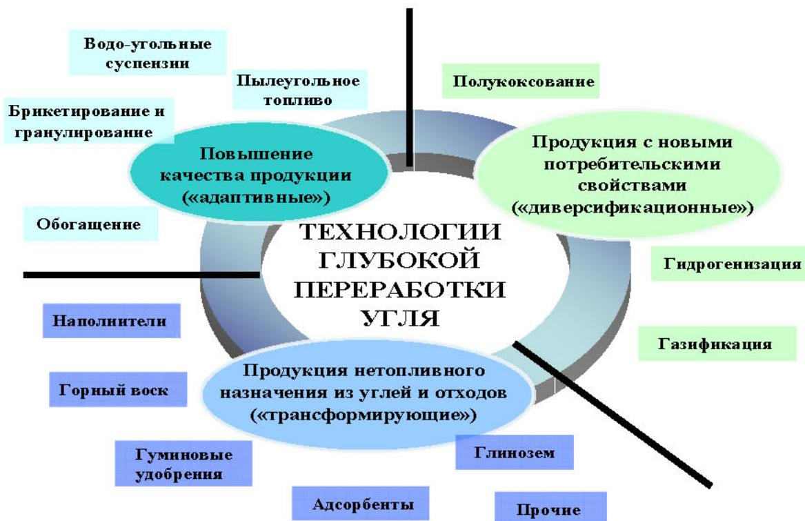
Рисунок. Классификация технологий комплексной переработки углей
