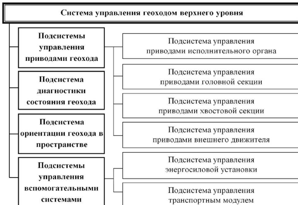
Рис. 1. Общая структура системы управления геоходом
