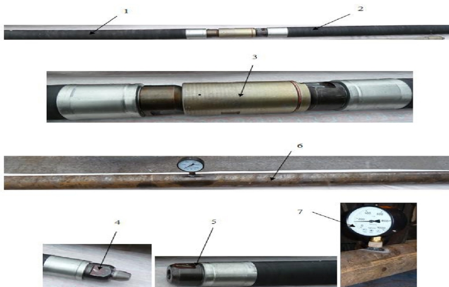
Рис.9. Разрывное устройство и имитатор угольной скважины: 1,2- упруго расширяющиеся рукава, 3-межпакерный клапан, 4-наконечник запорный, 5-муфта присоединительная; 6- имитатор угольной скважины; 7 – манометр (МПА).
