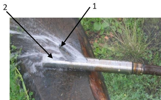
Рис.6. Внешний вид щелеобразователя: 1 – резец; 2 – корпус
