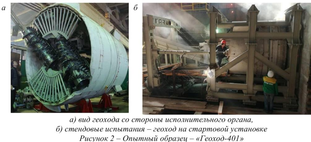
Рисунок 2 – Опытный образец – «Геоход-401»
