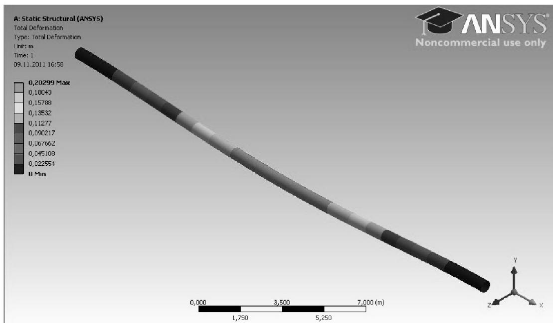
Рис. 5. Деформации, возникающие в газопроводе при осадке обводненного грунта
