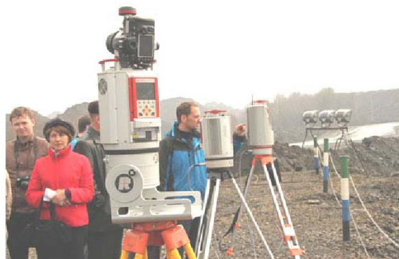
Рис. 1 Испытание лазерного сканера Riegl VZ-4000 на Барзасском разрезе
