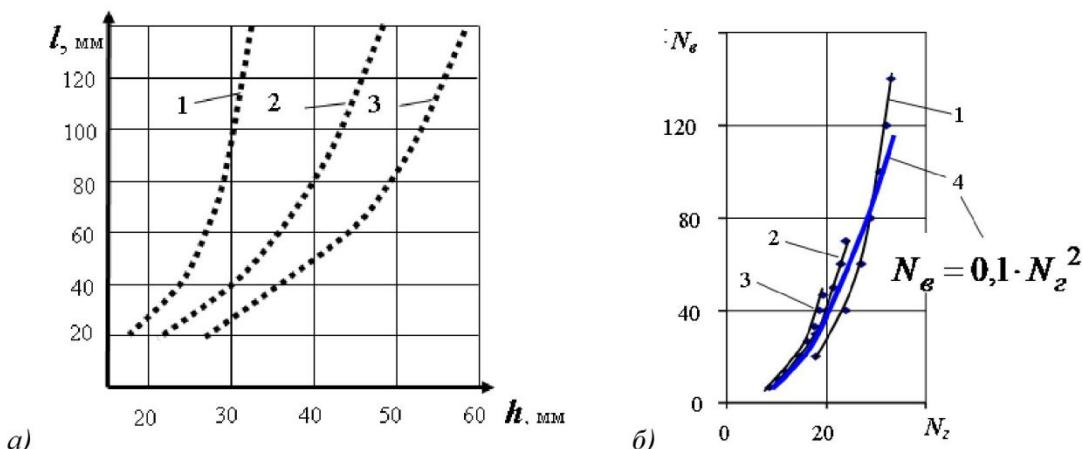
Рис. 2. Ширина параболы  $h$  после вычета диаметра выпускного отверстия (а) и зависимость между числом частиц по горизонтали  $N_r$  и вертикали  $N_v$  внутри зоны потока (б): 1 –  $d = 1$  мм; 2 –  $d = 2$  мм; 3 –  $d = 3$  мм; 4 – общая зависимость
