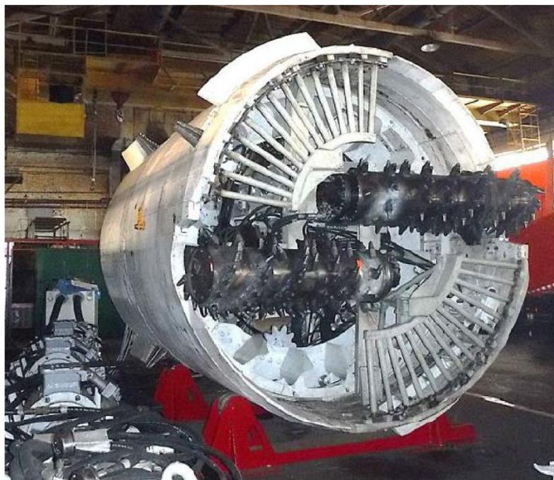
Рис. 1. Опытный образец геохода с барабанным исполнительным органом
