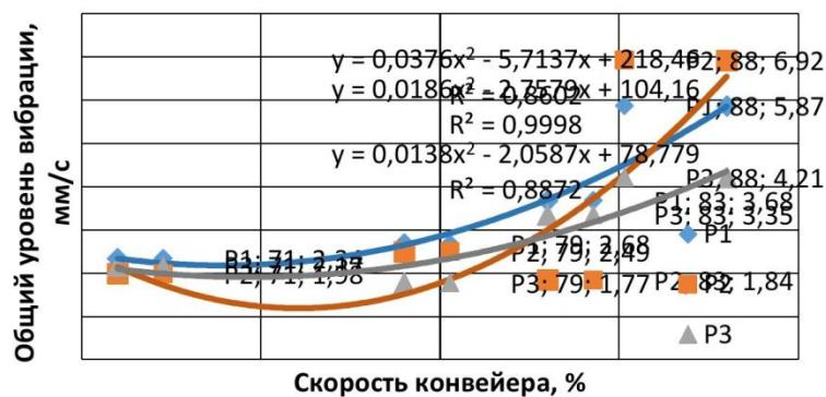
Рис. 12. График зависимости общего уровня вибрации в диапазоне 100-2000 Гц от скорости движения ленты конвейера
