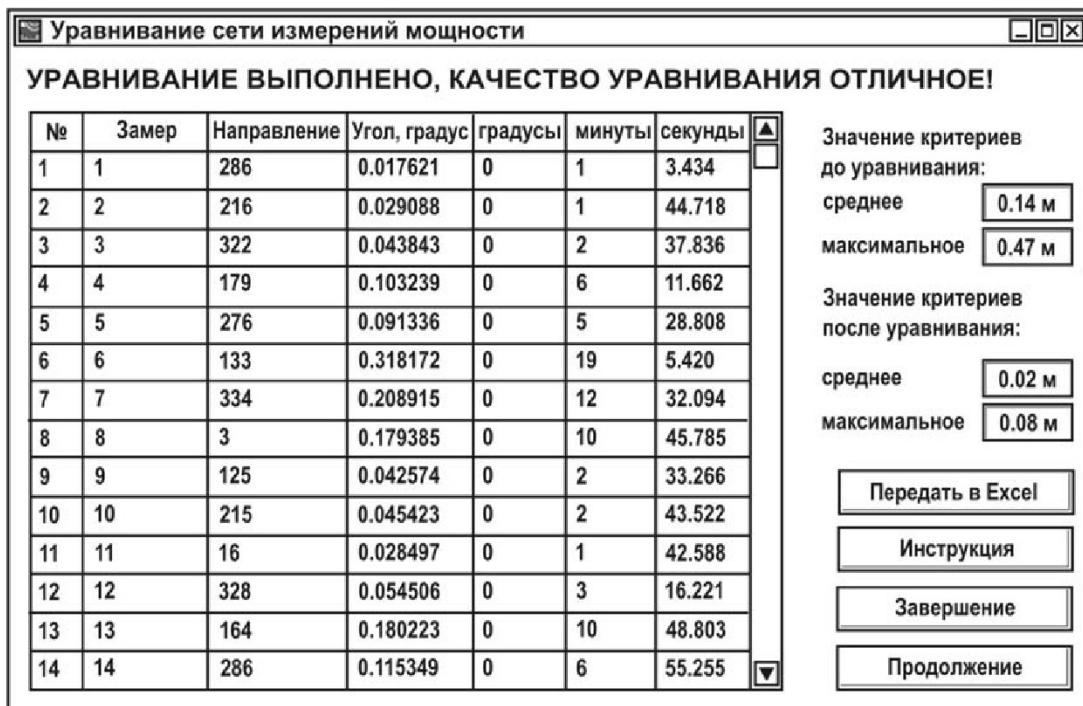
Рис. 3. Панель результатов уравнивания сети измерения мощностей
