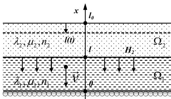
Рис.1. Расчетная схема грунтового массива при наличии фильтрационного потока
