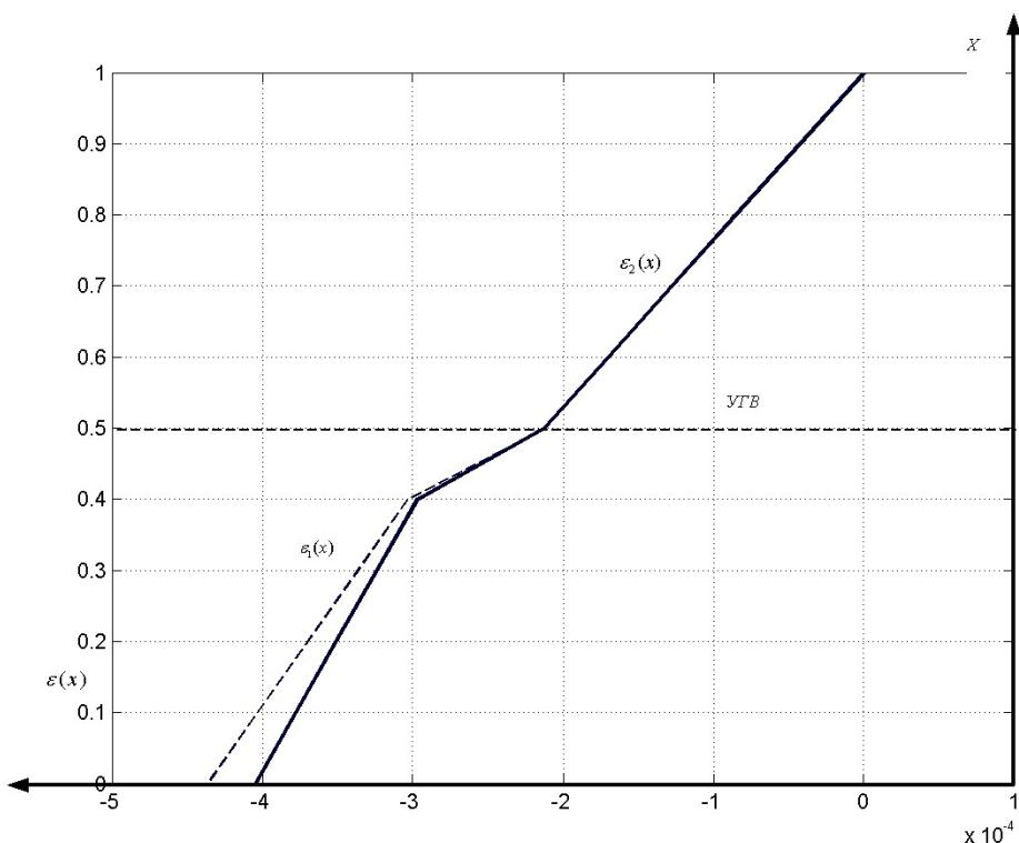
Рис. 3. График распределения деформаций в грунтовом массиве
