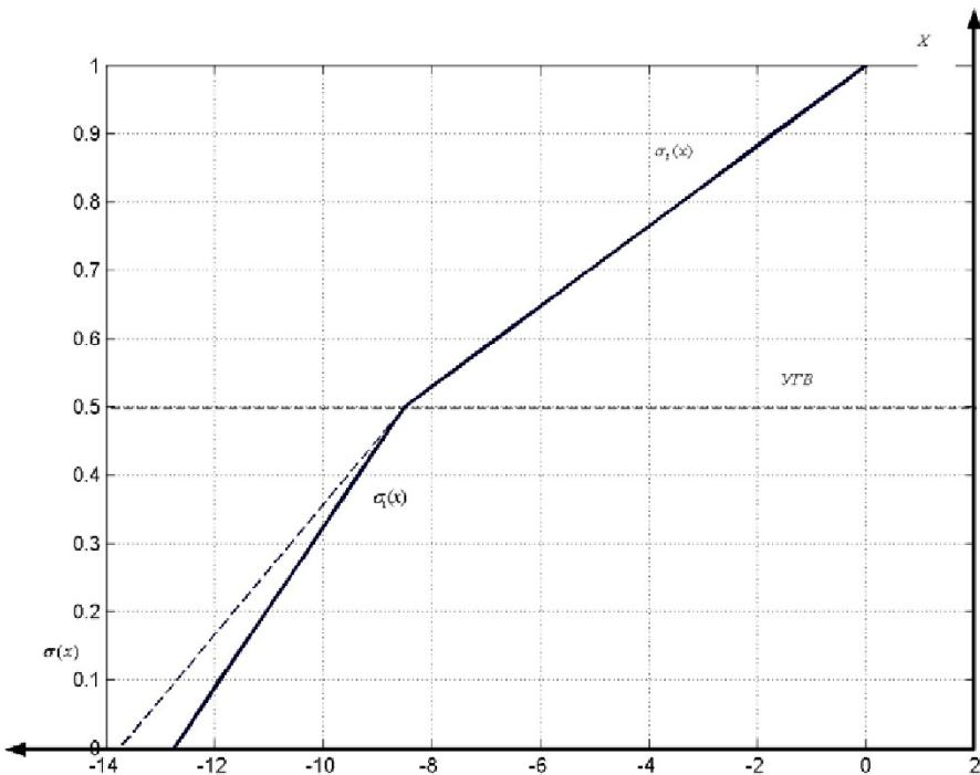
Рис. 4. График распределения напряжений в грунтовом массиве
