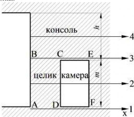
Рис. 6. Схема расположения характерных линий и точек в конструктивных элементах очистного блока
