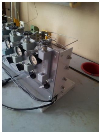
Рис. 11. Установки для исследования активности катализаторов очистки дымовых газов Fig. 11. Installations for studying the activity of catalysts for flue gas cleaning
