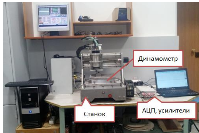
Рис. 5. Технологический комплекс гравирования технических надписей с контролем состояния режущего инструмента
